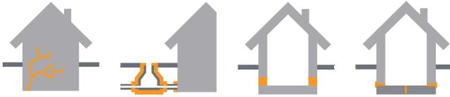
Le Grouttech 1420 s'applique pour fermer, colmater et remplir de façon limitée et élastique des fissures sèches et humides par le biais de techniques d'injection.
