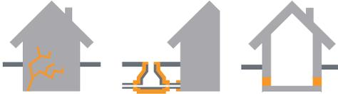
Scellement, colmatage et remplissage temporaire et rapide des fissures humides, des fissures sous venue d'eau ruisselante, des cavités et des crevasses dans le béton, la maçonnerie et la pierre naturelle.
