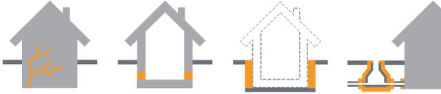
Scellement et colmatage temporaire et rapide des fissures sous venue d'eau ruisselante, des cavités et des fuites. La résine d'injection Grouttech 150 convient aux ouvrages en béton, en briques et en pierre naturelle dans maints domaines : génie civil, génie hydraulique, construction de ponts, de tunnels et de puits. Elle s'applique facilement avec une pompe bicomposant.
