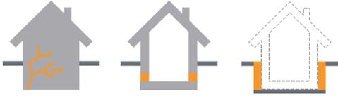
Scellement et colmatage temporaire et rapide des fissures sous venue d'eau ruisselante, des cavités et des fuites. La résine d'injection Grouttech 160 convient aux ouvrages en béton, en briques et en pierre naturelle dans maints domaines : génie civil, génie hydraulique, construction de ponts, de tunnels et de puits.
