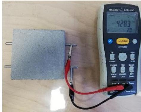
Figure 3 – Mesure de la résistivité (volumique) selon la méthode à électrodes encastrées (MIE).
