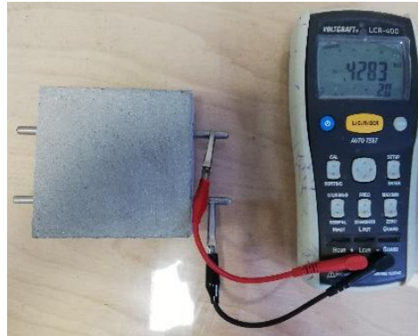
Figuur 3 – Meting van de (bulk)resistiviteit via de methode met ingebedde elektroden (MIE).
