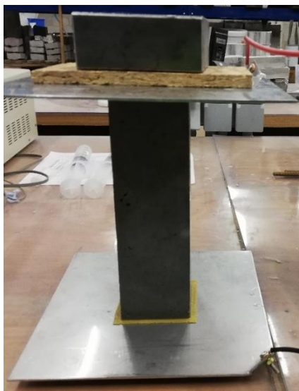
Figuur 2 – Meting van de (bulk)resistiviteit via de twee-elektroden methode (TEM) voor proefstukken bij 20°C en 100% RV (links) en proefstukken bij 20°C en 60% of 80% RV (rechts).
