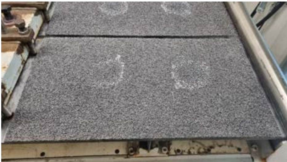
Figuur 2 – Ingeklemd proefstuk. De witte vlekken zijn afdrucken van de geleidende vloeistof en indiceren de locaties van de weerstandsmetingen.
